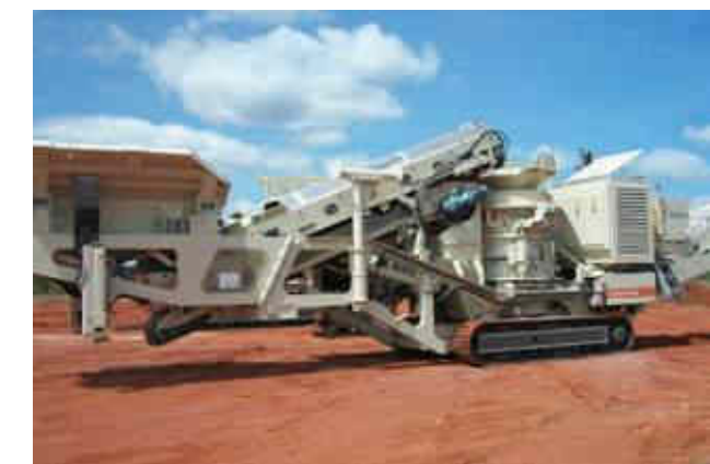
El Lokotrack LT300HP está disponible con un alimentador de banda o bien con un alimentador vibratorio grizzly.
