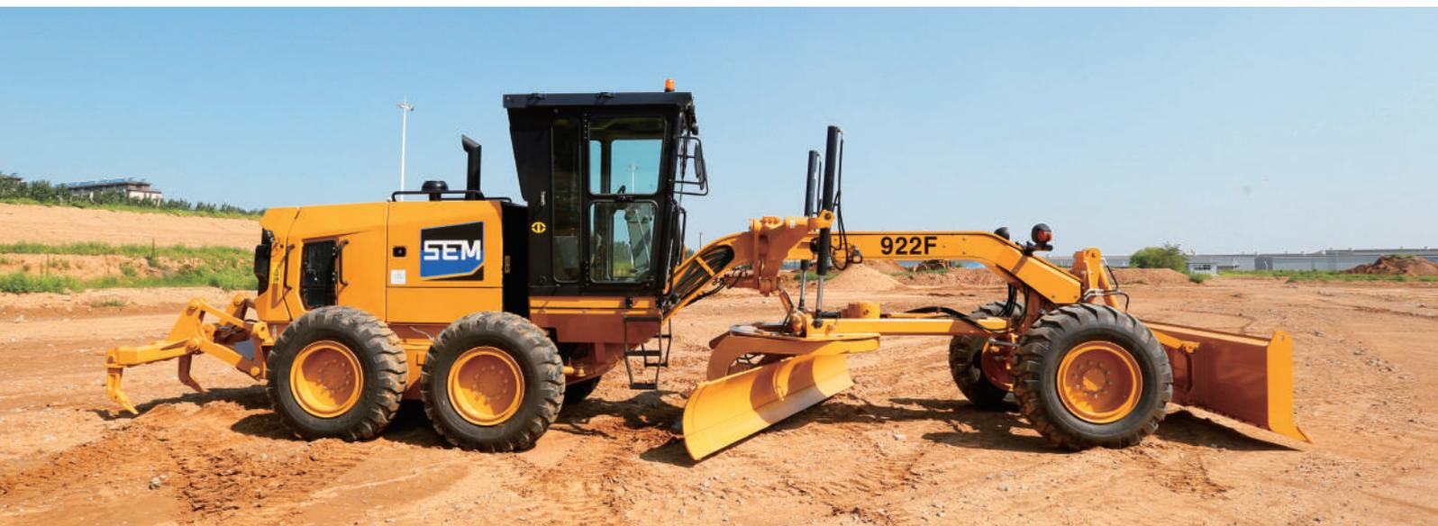
Las aplicaciones típicas incluyen nivelación, nivelación final, cortar taludes, zanjas, limpieza de zanjas, remoción de nieve. Él es un equipo esencial para la construcción de carreteras, proyectos de conservación de vías fluviales de tormenta y transformación de tierras de cultivo y nivelación.
