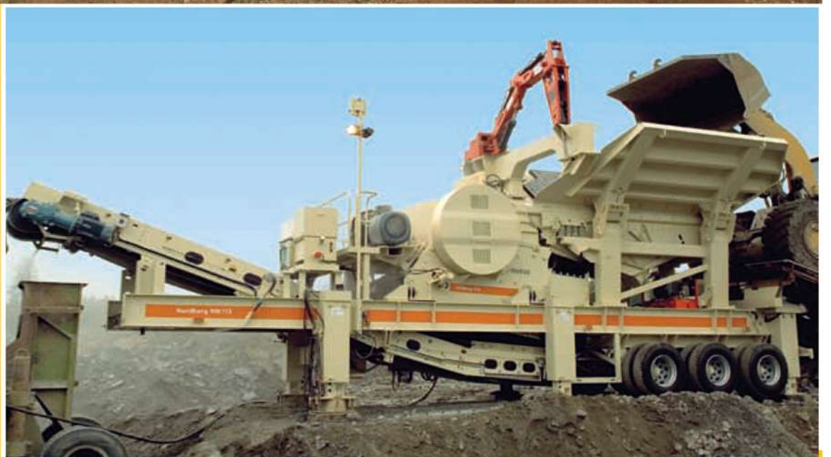
Plantas portátiles sobre remolques
