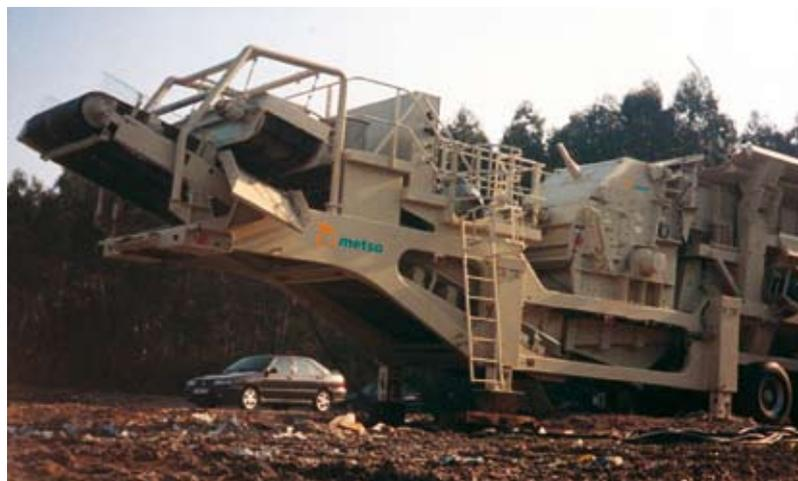
Aplicación móvil : molinos de impacto NP1315 instalado en Nordwheeler
