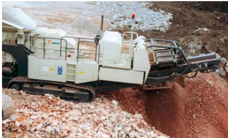
Aplicación en reciclaje : molinos de impacto NP1007 instalado en Lokotrack
