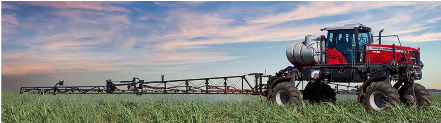
La pulverizadora MF9030 brinda la máxima productividad, rendimiento y durabilidad con la más avanzada tecnología, ofreciendo una protección completa de la siembra a la cosecha. Su chasis Flex Frame (Flexible) absorbe las irregularidades del terreno, manteniendo la tracción en sus ruedas y la estabilidad del aguilón en mayores velocidades de aplicación.
