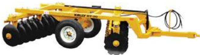
El bastidor principal y los soportes de las distintas secciones son de acero estructural de gran resistencia a la torsión; los ejes son de acero de alto carbono en redondo de 1 1/2 con cajas portatableros y baleros engrasables que le dan una mayor vida útil y protegen tu inversión. Estas rastras cuentan con un sistema de nivelación y transferencia de potencia de muelle de 3 hojas, para que lleve a cabo cada trabajo de manera sencilla.
