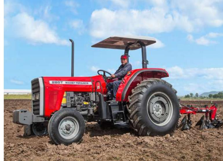
El MF285 está equipado con una transmisión de 8 velocidades al frente por 2 de reversa y el confiable Sistema Hidráulico Ferguson con un caudal hidráulico total de 60 l/mn, con una capacidad de levante a las esferas de hasta 1,906 kgf.
